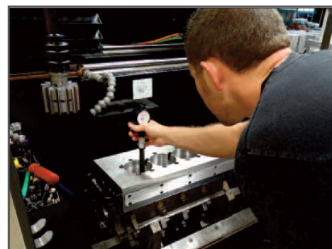
Operator honownicy SV20 dokonuje pomiaru cylindra przy pomocy średnicówki Sunnen.
