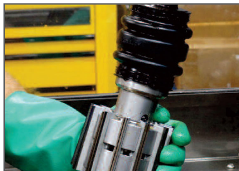
„Głowica honująca z dwunastoma osełkami diamentowymi zapewnia najlepszą dokładność cylindra”, mówi Ferri.
